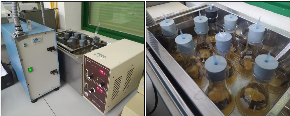
**Figura 15. 15a:** Sistema de baño termostatzado con dedo frío acoplado; **15b:** Mostos en fermentación.
