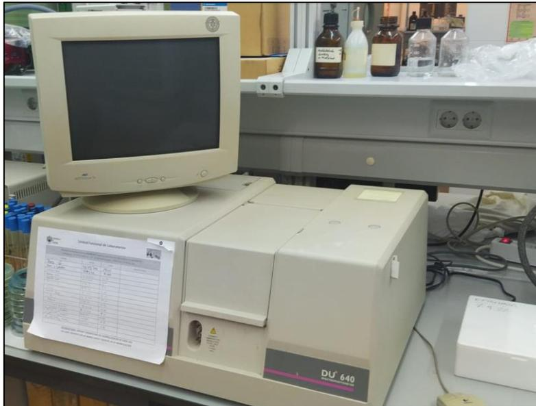
**Figura 20.** Espectrofotómetro UV-VIS.
