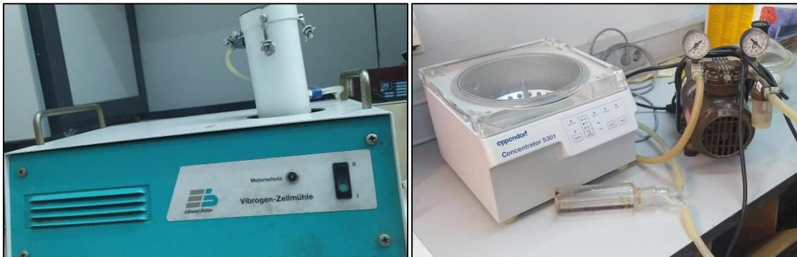
**Figura 19.** 19a: Agitador Vibrogen; 19b: Secador de vacío SpeedVac.
