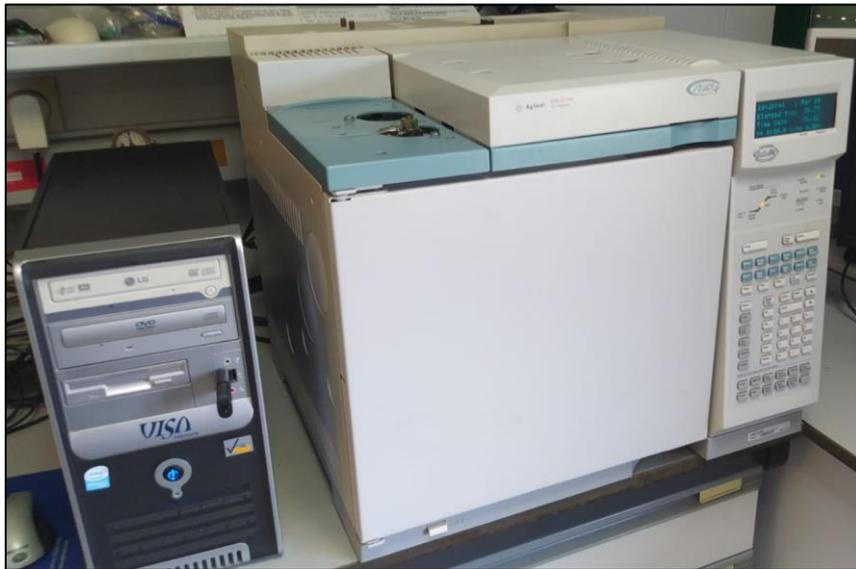
Figura 17. Equipo GC-FID empleado para la detección de compuestos mayoritarios.
