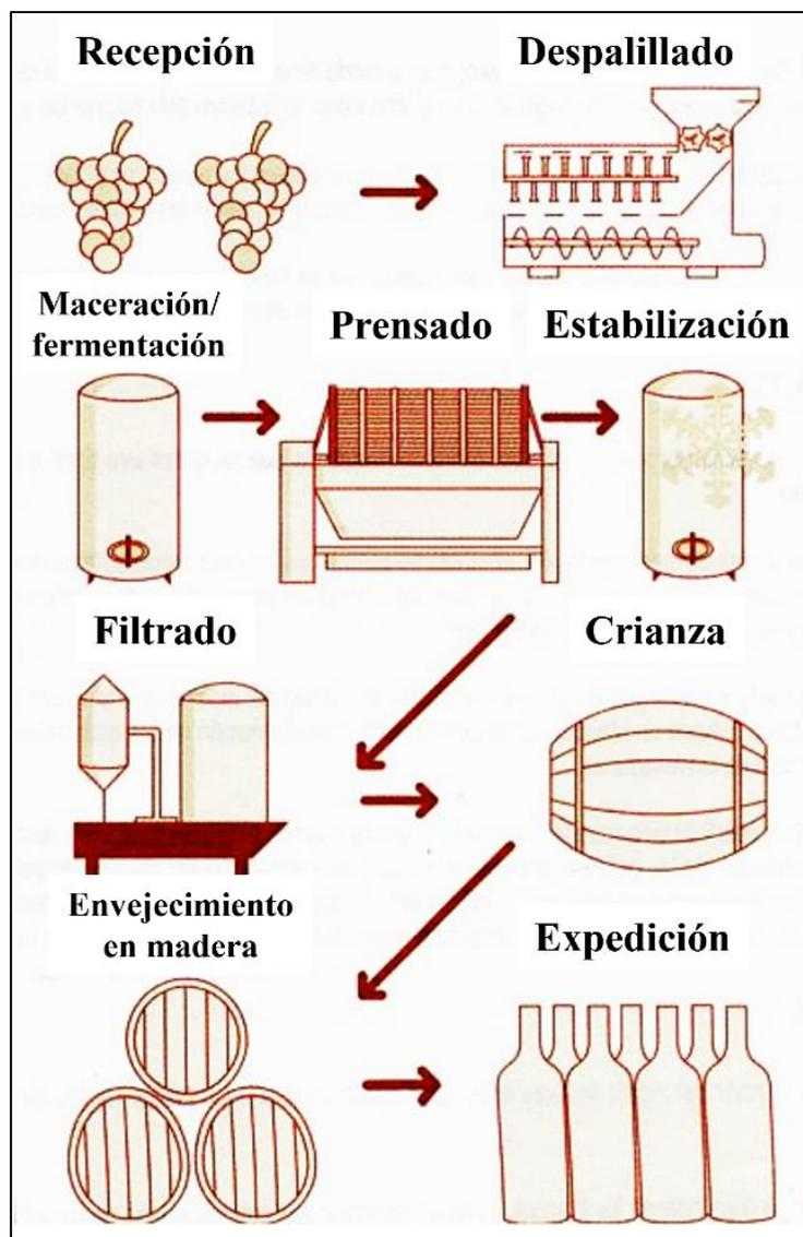
**Figura 7.** Resumen esquematizado del proceso general de vinificación. Fuente: Modificación propia a partir de *Catadelvino.com* (s. f).
