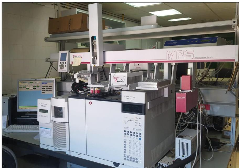
**Figura 18.** Equipo GC-MS empleado para la detección de compuestos volátiles minoritarios.
