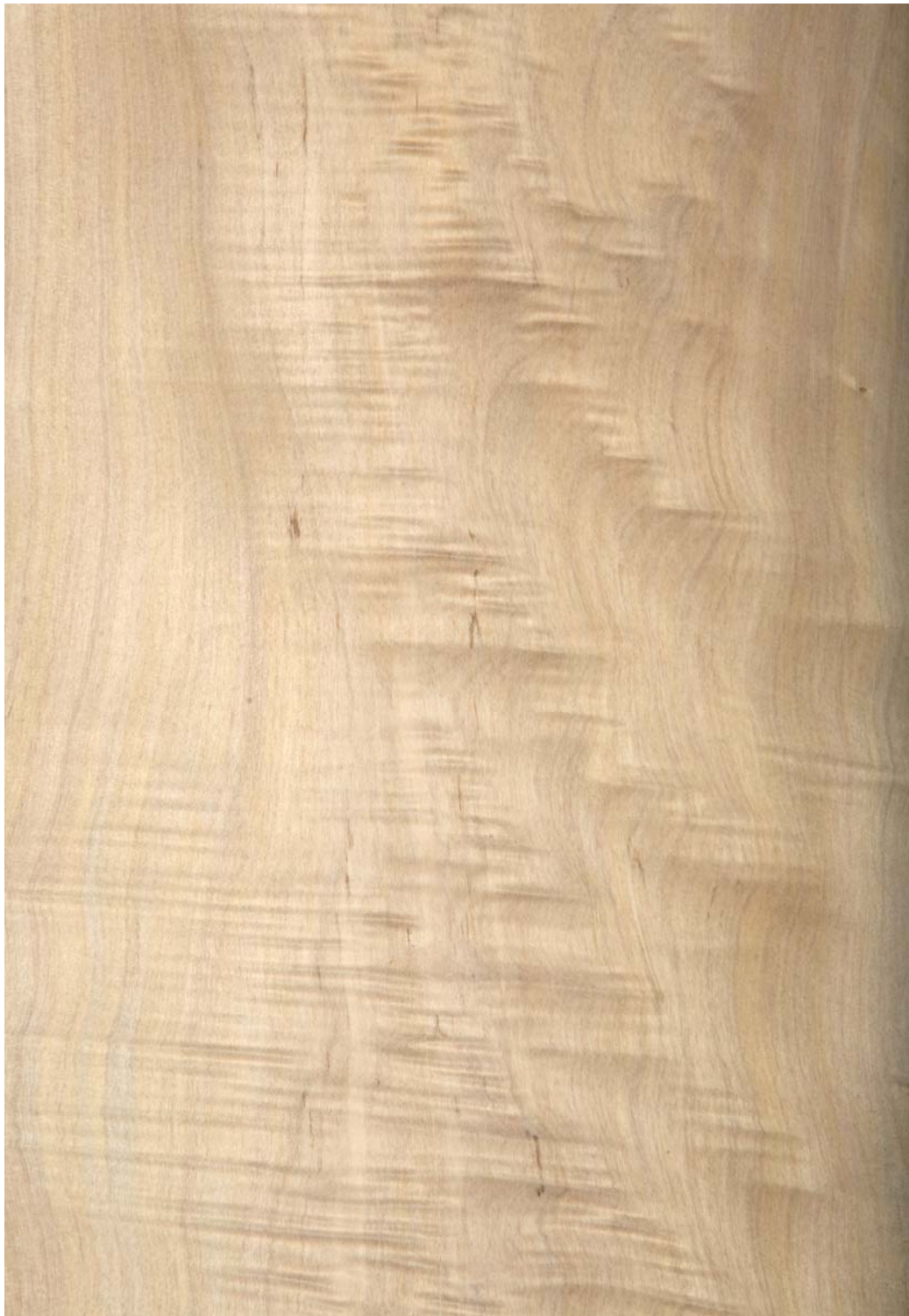
Figura 48. Plano longitudinal tangencial de R. rospigliosii (municipio de Angostura, departamento de Antioquia).
