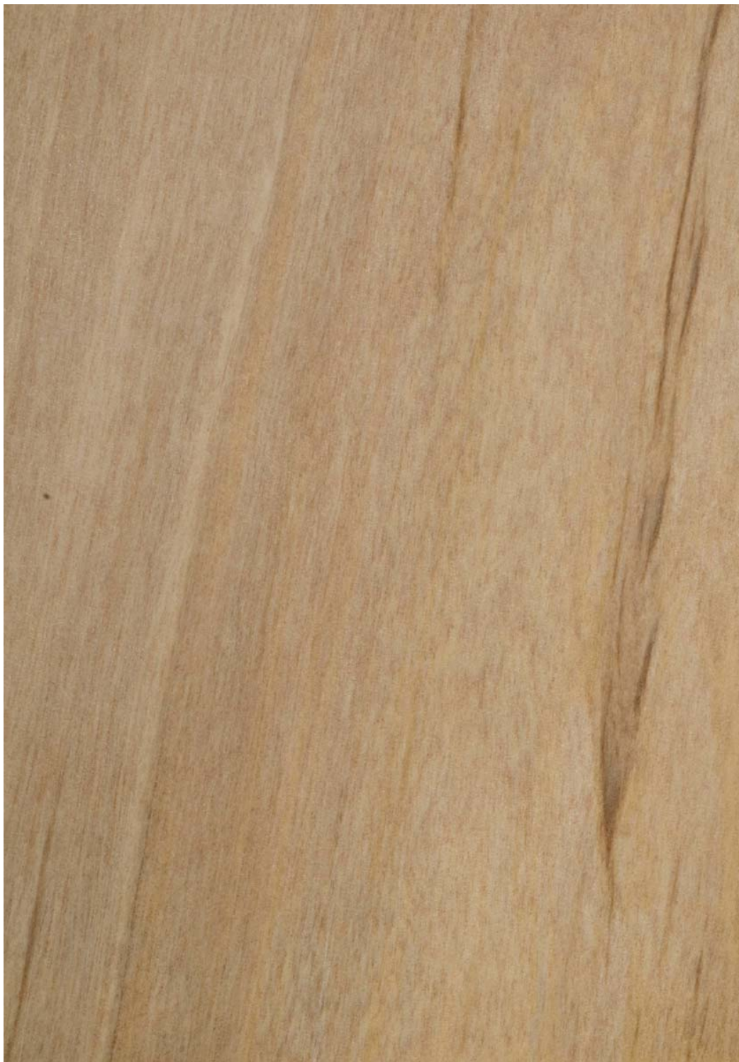
Figura 32. Plano longitudinal tangencial de P. oleifolius (municipio de Yolombo, departamento de Antioquia).
