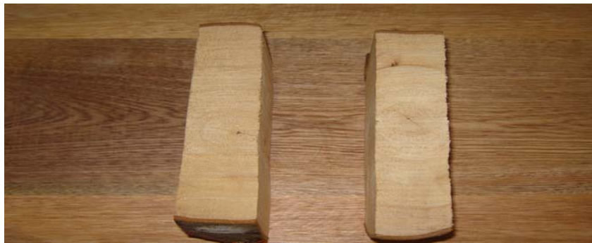
Figura 6. Muestras diametrales utilizadas para determinar la variación de la densidad básica y las dimensiones de las traqueidas.
