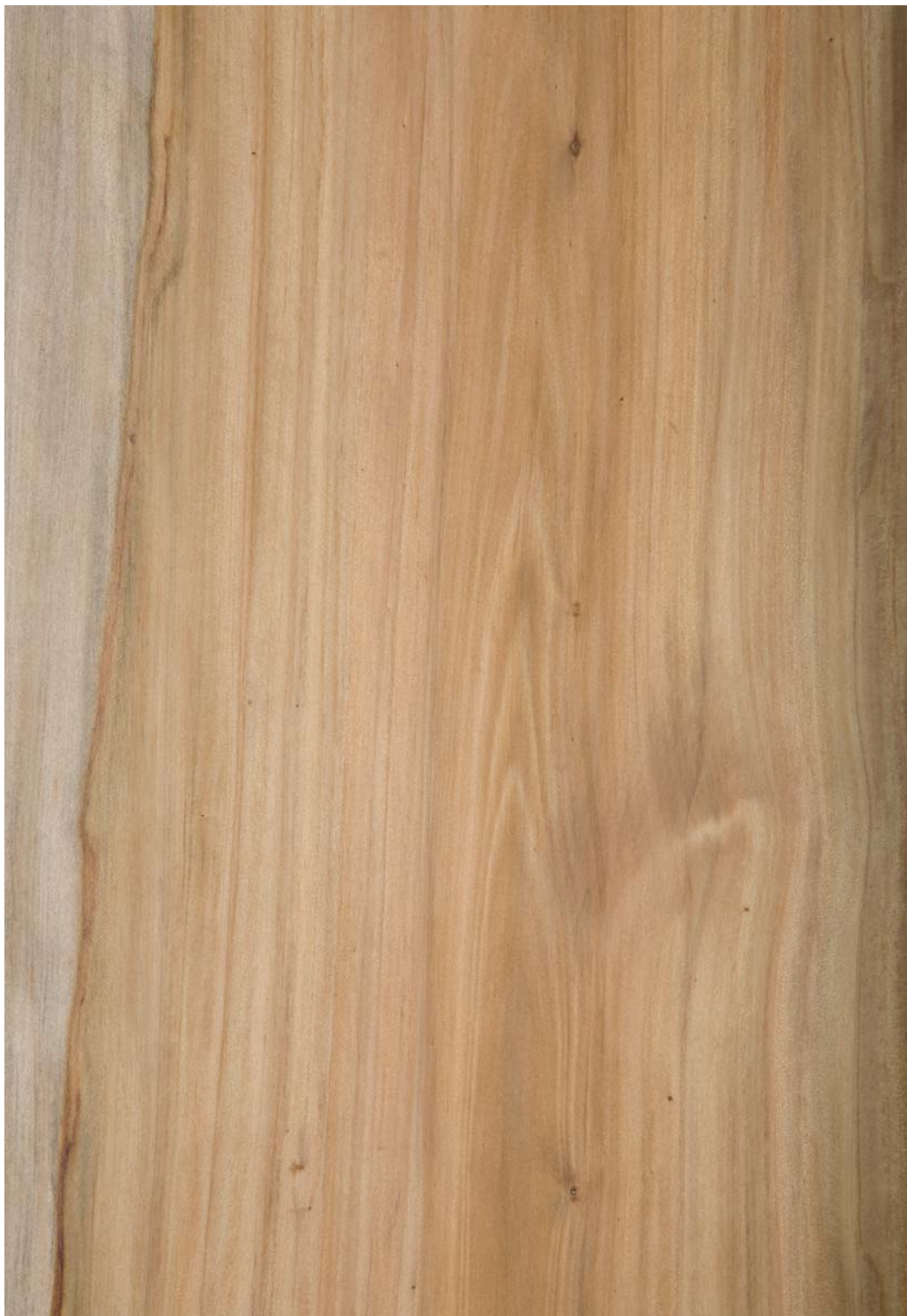
Figura 40. Plano longitudinal tangencial de P. montana (municipio de Belmira, departamento de Antioquia).
