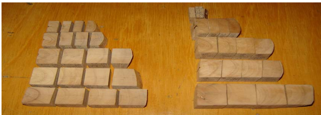
Figura 7. Submuestras utilizadas para determinar la densidad básica de la madera en dirección radial (médula-corteza), obtenidas de seccionar los radios a diferentes alturas del tronco.
