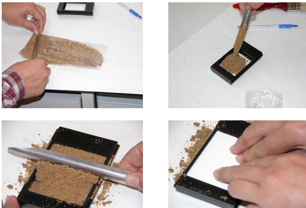
Figura 3. Proceso de llenado de las cápsulas del equipo Foss NIRSystem 6500.
