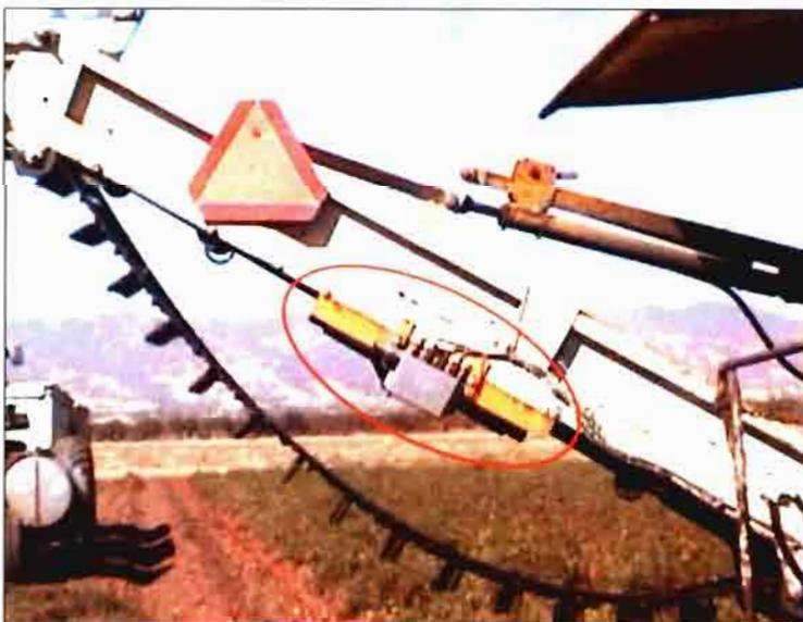
Foto 2. Unidad de pesado continuo en la cadena y célula de carga.
