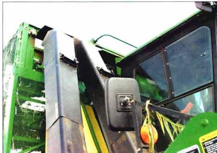
Foto 4. Situación del sensor óptico en la cosechadora de algodón.
