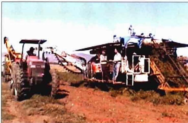
Foto 1. Cosechadora de tomate equipada con monitor de rendimiento.
