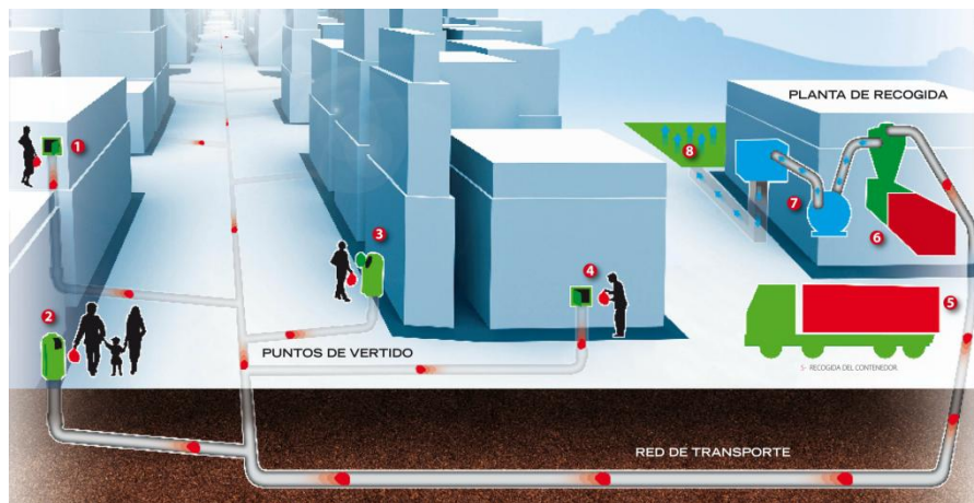
Figura 5.8: Sistema de Recogida Neumática Tipo
