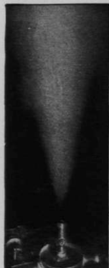
Vapor a la presión de 7 kilogramos sobrecalentado en 5°.
