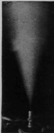
Vapor á la presión de 4 kilogramos con 1,94 % de humedad.
