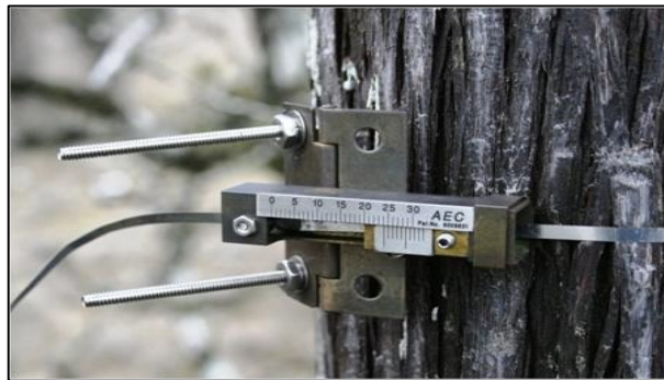
Figura 1. Dendrómetro colocado sobre el tronco de una sabina ( Juniperus phoenicea ).
