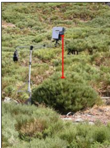
Figura 12. Trípode con GER 2600 midiendo un Cytisus . www.geogra.uah.es/espectra/
