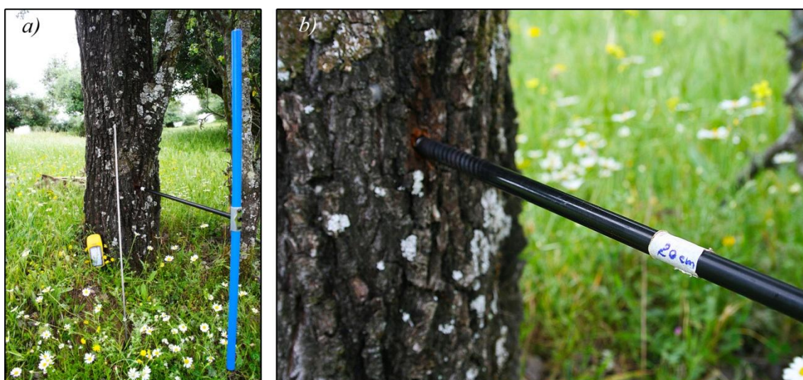
Figura 30. a) Barrena y extractor Haglöf. b) Detalle de la barrena extractora.
