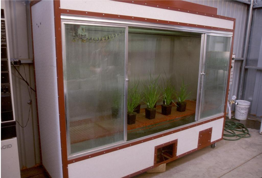
**Figura 3.10.** Máquina de laboratorio de aplicación de herbicidas, donde se controla la presión, el volumen, la velocidad y la altura de la aplicación.
