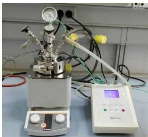
Figura A.9. Reactor a presión Berghof HR-10.
