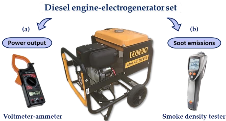
Figura A.11. Esquema de la metodología experimental empleada en la determinación de: la potencia generada por el motor utilizando un voltímetro-amperímetro (a) y; las emisiones de hollín con un opacímetro (b).
