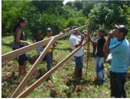
Figura 21. Aula práctica para implantación de curva de nivel realizado agricultores de la REATA del municipio de Itacoatiara.
