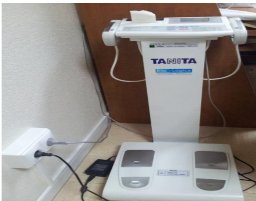
Figura 10. TANITA® BC 418 NA segmental, tetrapolar, usada en el presente estudio.
