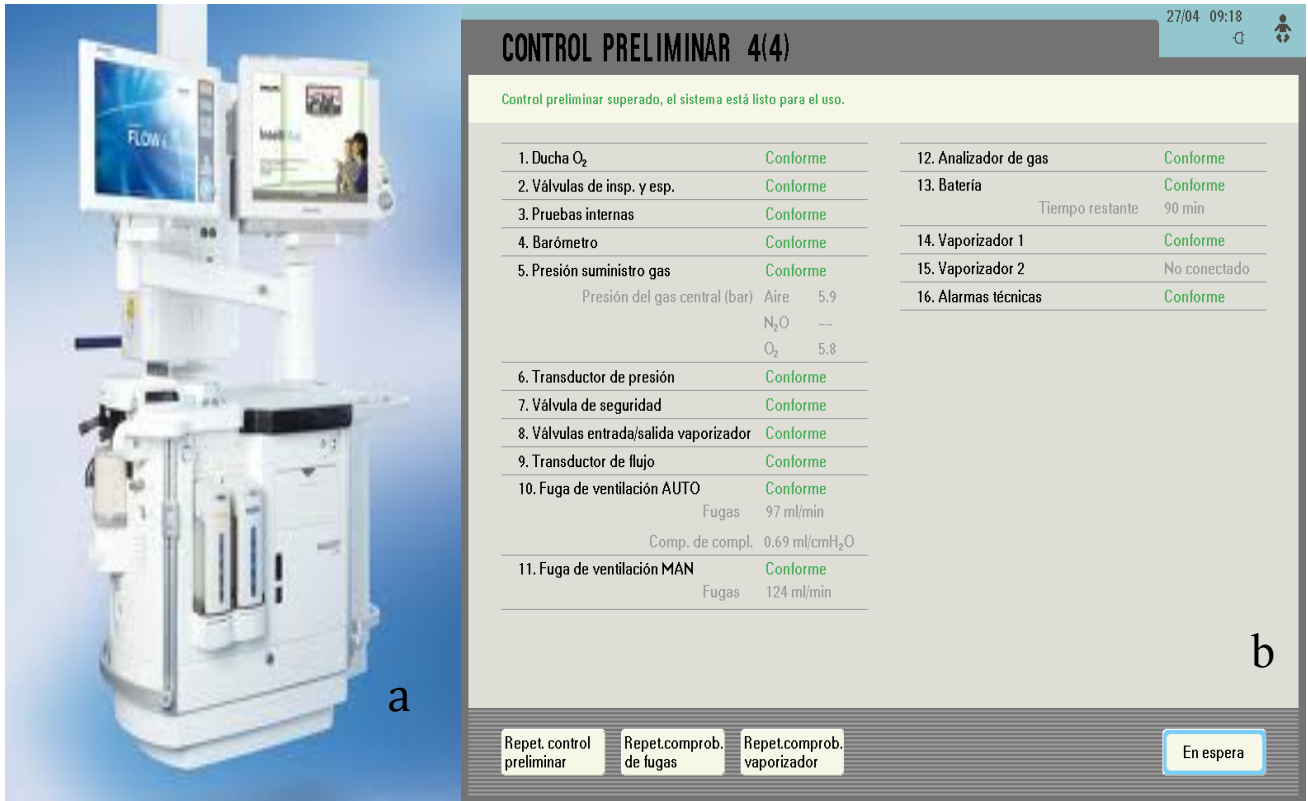
Figura D2. a). Respirador Flow-i Maquet®. Utilizado en quirófano durante anestesia de pacientes neonatos. b). Captura de pantalla del respirador Flow-i® antes de la realización de cada uno de los experimentos.
