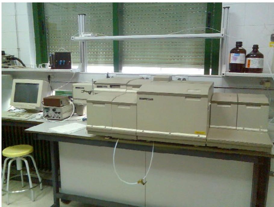
Figura 4.27. Vista general del equipo FT-IR-Raman (Perkin Elmer Spectrometer, System 2000) situado en el Departamento de Química Orgánica.
