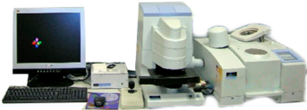
Figura 4.1. Espectrómetro Spectrum One NTS FT-NIR situado en el SCAI de la Universidad de Córdoba.
