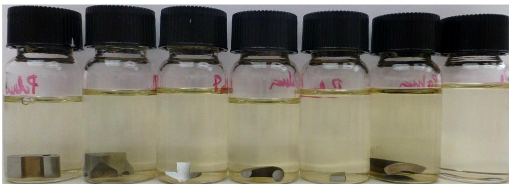
Figura 4.4. Muestras en EMP tras 1100h de experimento. De derecha a izquierda, sin pieza, pieza 1, pieza 2, pieza 3, pieza 4, pieza 5 y pieza 6.
