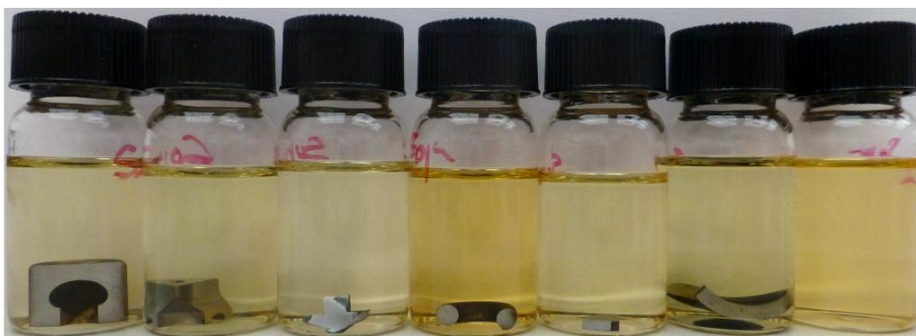
Figura 4.5. Muestras en EMS tras 1100h de experimento. De derecha a izquierda, sin pieza, pieza 1, pieza 2, pieza 3, pieza 4, pieza 5 y pieza 6.
