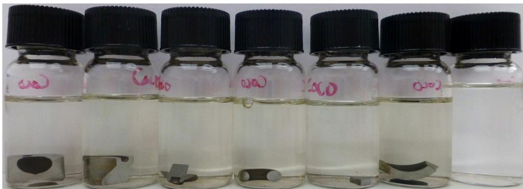
Figura 4.2. Muestras en EMCO tras 1100h de experimento. De derecha a izquierda, sin pieza, pieza 1, pieza 2, pieza 3, pieza 4, pieza 5 y pieza 6.
