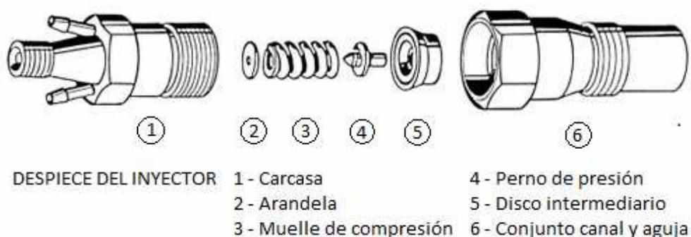
Figura 4.1. Inyector y su despiece
