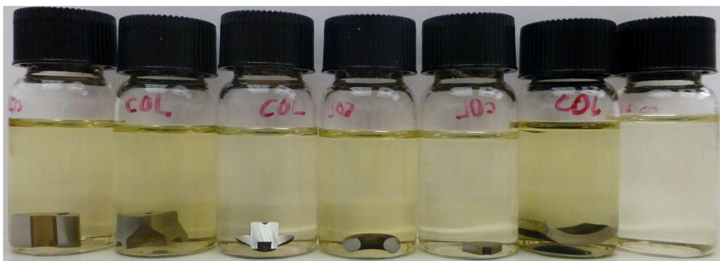
Figura 4.3. Muestras en EMC tras 1100h de experimento. De derecha a izquierda, sin pieza, pieza 1, pieza 2, pieza 3, pieza 4, pieza 5 y pieza 6.
