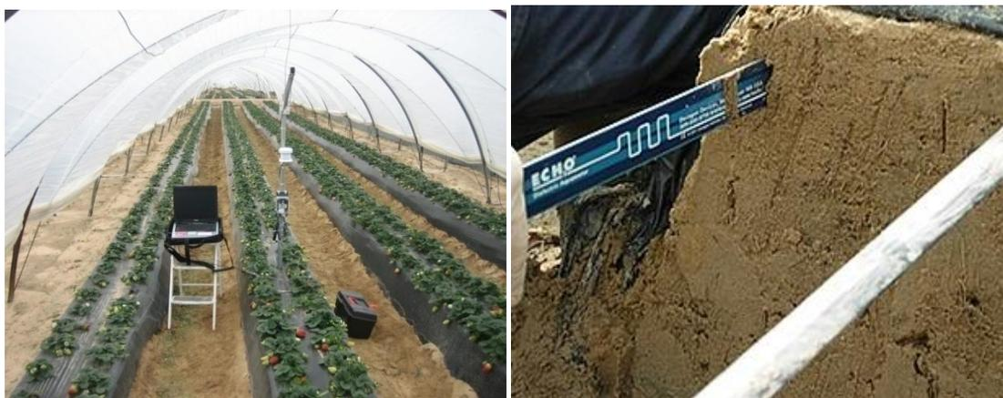
*Figura 6.5. Estación climática y sensores de humedad instalados en campo*
