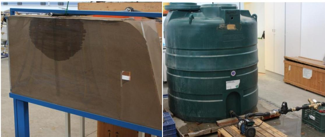
*Figura 5.1. Urna para la medida de bulbo húmedo y elementos auxiliares para la instalación del gotero*
