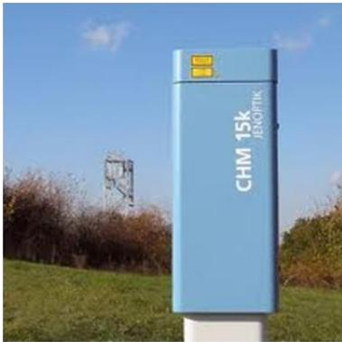
Ilustración 18. Ceilómetro CHM 15k | 15k-x
