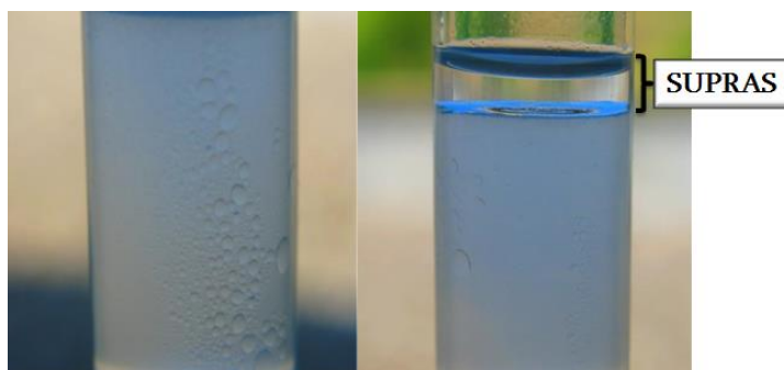
Fig. 10. Gotitas del SUPRAS formado por 1-decanol en tetrahidrofurano/agua antes y después de la etapa de centrifugación.
