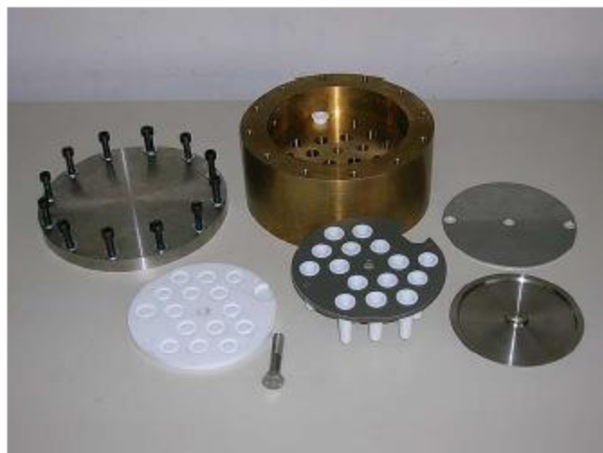
Figura I.9. Fotografía que muestra el multiautoclave diseñado por Caremans y col. [132] con capacidad para quince síntesis en paralelo.
