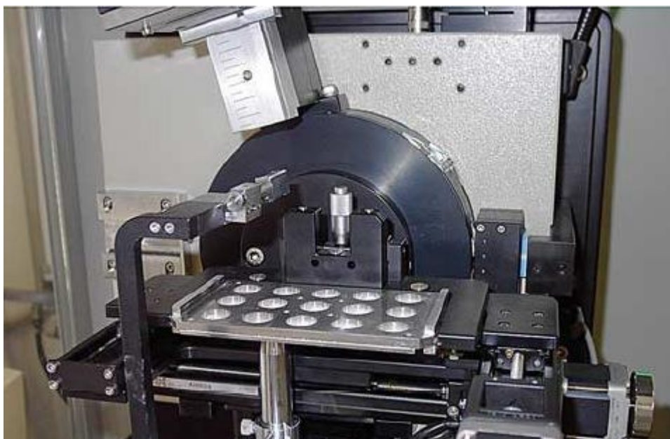
Figura I.10. Fotografía que muestra la caracterización de muestras por DRX en una plataforma X-Y-Z utilizada por Caremans y col. [132].
