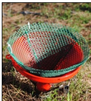
Figura 3.19. Detalle del embudo utilizado para la medida de la trascolación en Pinus pinea
