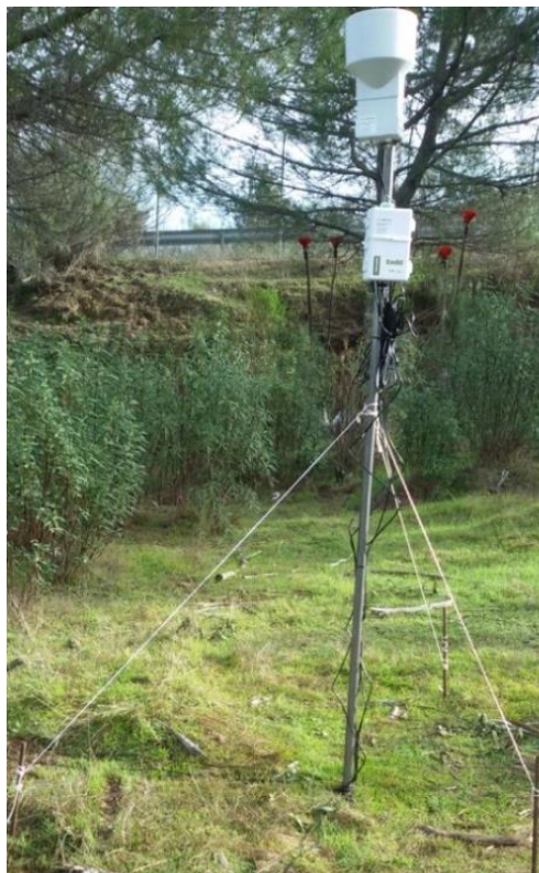
Figura 3.12. Pluviómetro Decagon instalado en la zona antropizada.
