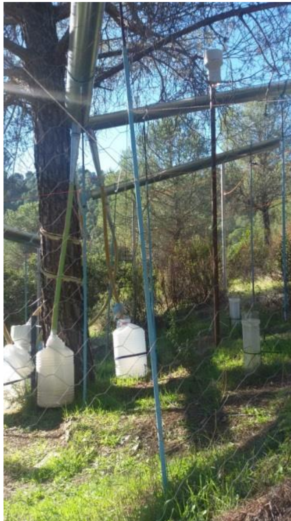
Figura 3.17. Instrumentación empleada actualmente para la medida de la trascolación en los ejemplares de Pinus pinea ubicados en la zona del Arroyo los Morales.
