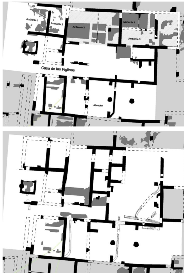
Fig. 371. Hispalis : planta de la “casa de las Figlinas” (arriba) y del mismo inmueble tras su transformación en una vivienda comunitaria (abajo). Modificado a partir de GONZÁLEZ ACUÑA, 2011a, fig. VII. 133 y fig. VII. 209.
