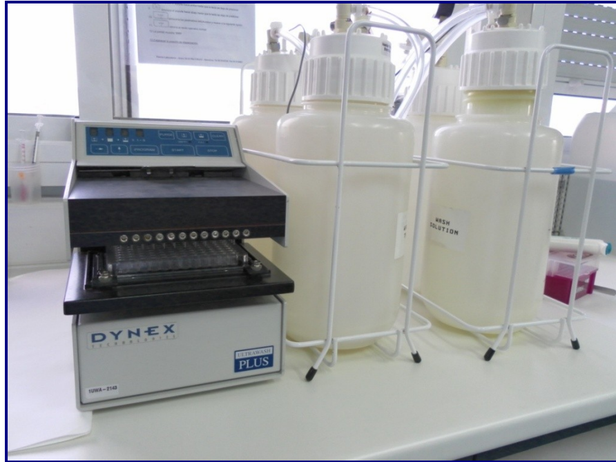
Figura 3. Lavador de microplacas. Dynex ultra wash plus ® , utilizado en el proceso de incubación del anticuerpo revelador.
