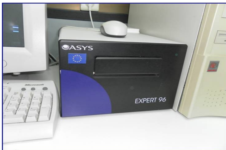
Figura 4. Imagen del lector de microplacas Asys Expert 96 ® , usado para la medición de la absorbancia a 492 nm.
