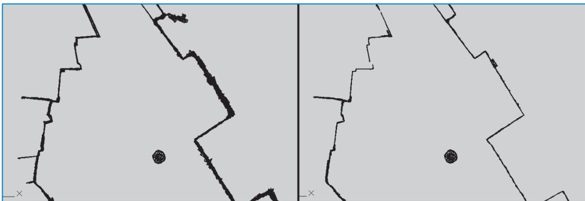
**Ilustración 140: Obtención de líneas más definidas como resultado de la limpieza de mallas en AutoCAD.**
