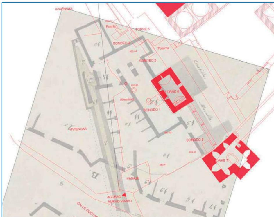
**Ilustración 103:** Superposición del plano de Cancillería y plano Arqueológico tomando como punto coincidente la torre 6 del castillo.
