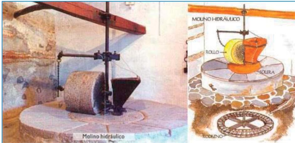
**Ilustración 73: Mola Olearia presente en Nigüelas reconstruida con piezas originales y extrapolada por semejanzas a la almazara de estudio. Fuente: [www.adurcal.com](http://www.adurcal.com)**
