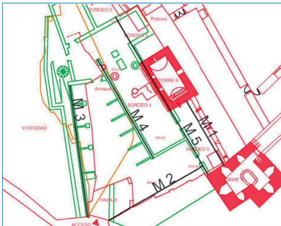
**Ilustración 127: Medición en metro de las distancias modelo en el plano que se empleará para el levantamiento.**
