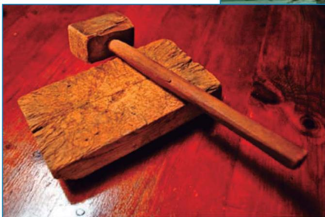
**Ilustración 91: El instrumental para partir las aceitunas, martillo o machacador de madera y tabla. (Corchuelo-Amaya, et al., 2010).**
