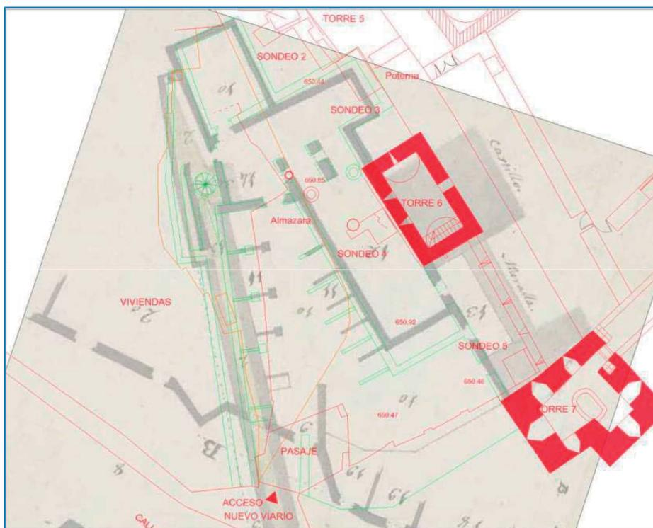
**Ilustración 147:** Replanteo de la planta de la Almazara (en verde) cotejando los planos de Antonio de Leyba (sombreado) y arqueológicos (rojo) y las mediciones con escáner láser.
