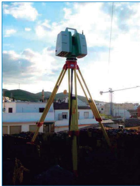
Ilustración 129: Estación láser-escáner subida a la torre 7 del Castillo de Priego para medir aquellas zonas tapadas desde el nivel del suelo.
