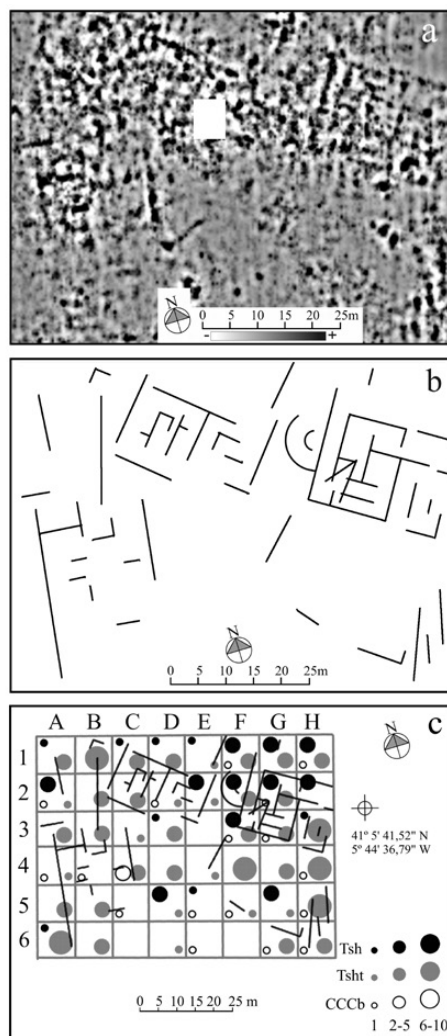
Fig. 4. Villa romana de Los Villares (Forfoleda). 4a: Resultados de la prospección con georadar. Profundidad de lectura entre 0,31 y 0,45m bajo la superficie. 4b: Interpretación de las estructuras detectadas por fotografía aérea y georadar. 4c: Patrón de distribución de la cerámica: Tsh: terra sigillata hispánica (lisa y a molde), Tsht: terra sigillata hispánica tardía (lisa y a molde), CCCb: Cerámica común de cocina decorada con líneas bruñidas (los números indican rangos en el número de fragmentos).
