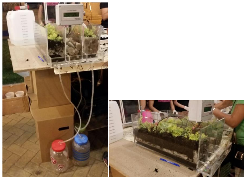
Figura 3: Modelo a escala de techo verde. A la izquierda se aprecia el sistema de recogida del agua de percolación. A la derecha se aprecian las diferentes capas del techo verde.
