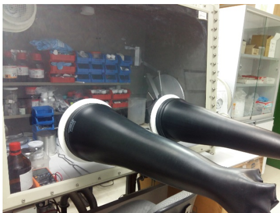
Fig. 3.22. Caja de guantes MBraun con atmósfera de argón.
