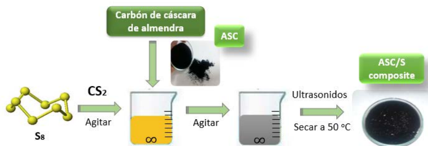
Fig. 3.5. Esquema para la síntesis del composite de Carbón activado de biomasa-Azufre.
