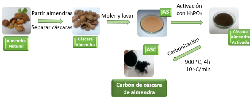
Fig. 3.3. Esquema para la síntesis del carbón activado de cáscara de almendra.
