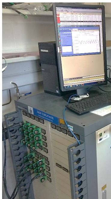
Fig. 3.26. Potenciostato-galvanostato Arbin BT2143 utilizado para las medidas galvanostáticas.
