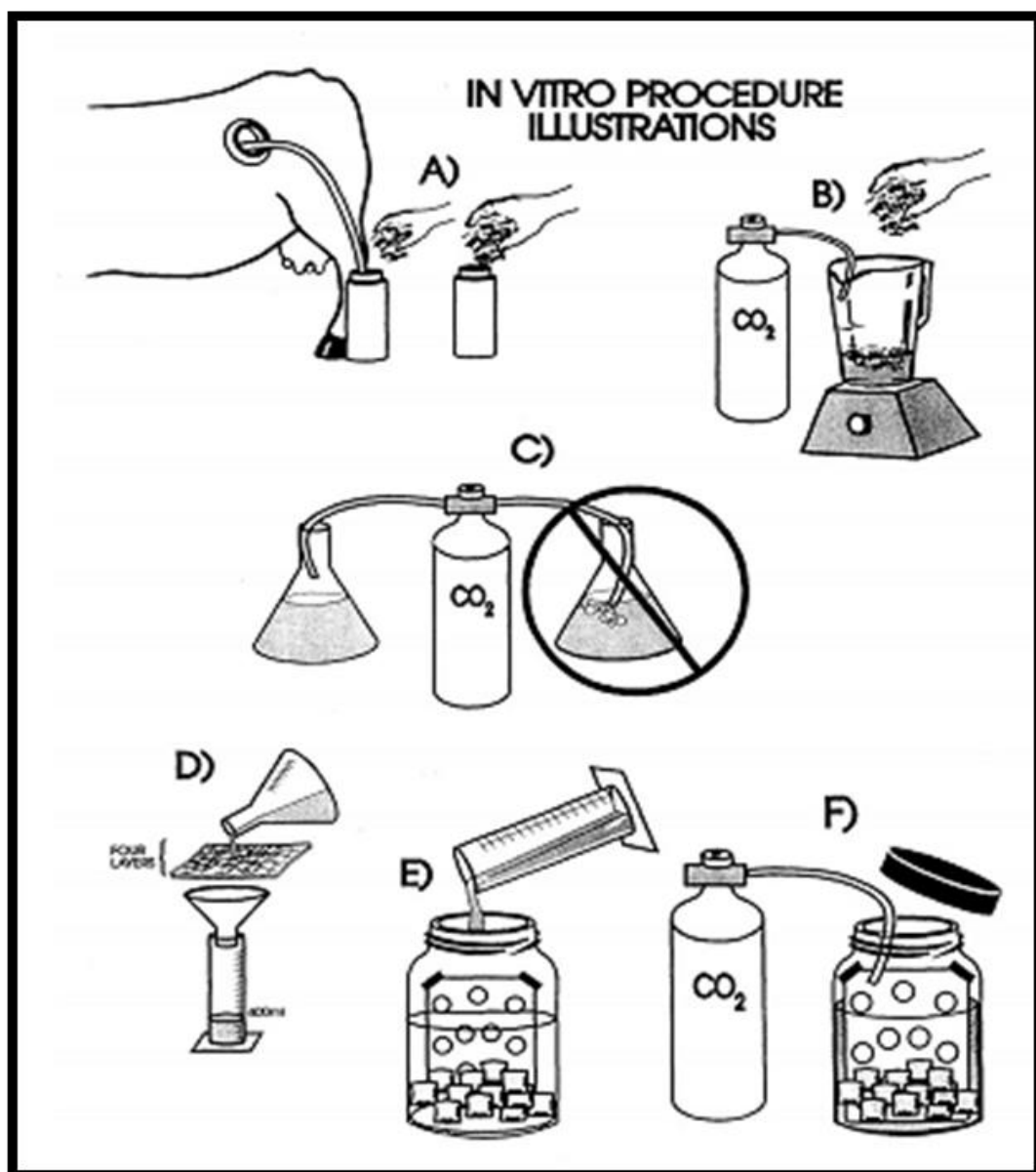
Figura 17. Esquema de la metodología de degradabilidad in vitro con incubadora DAISY II.
