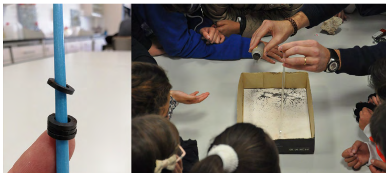
Figura 6.3. Levitación magnética (izquierda) y líneas de campo dibujadas con virutas de hierro (derecha).
