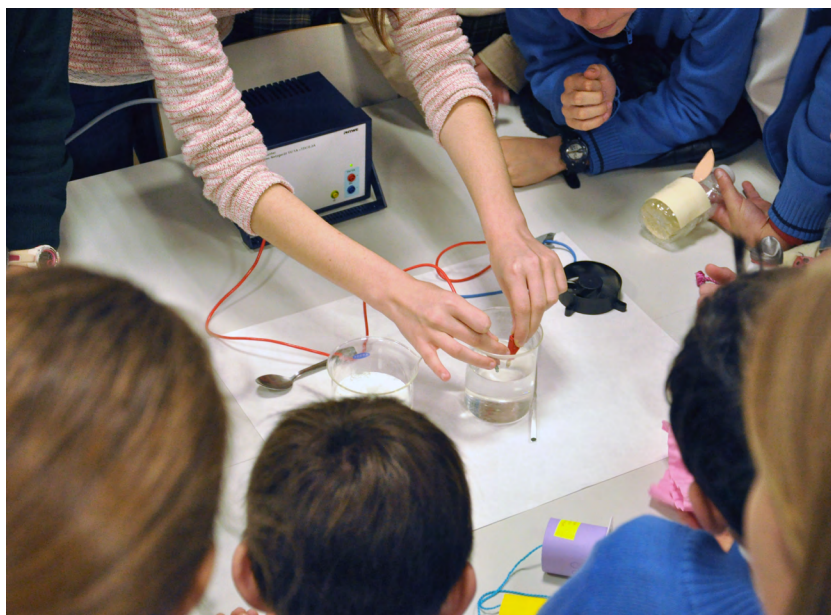
Figura 6.7. Montaje experimental para realizar el experimento de la conductividad del agua.
