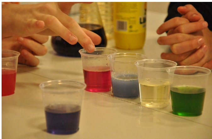
Figura 6.4. Vasos con agua obtenida de hervir col lombarda y con distintos ácidos o bases disueltos.
