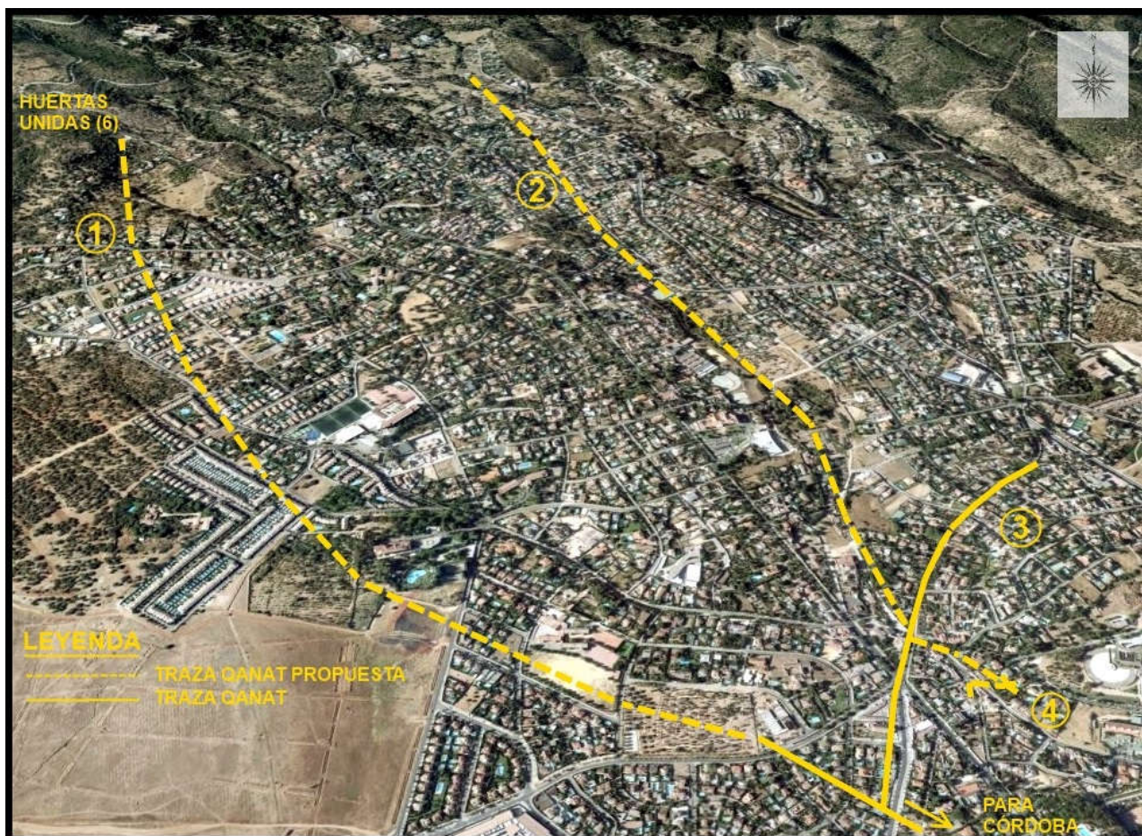
Foto (79). Representación de la traza de los cuatro ramales del qanat de El Duende (elaboración propia sobre la base de Google Earth año 2007, escala aproximada 1: 7.000).
