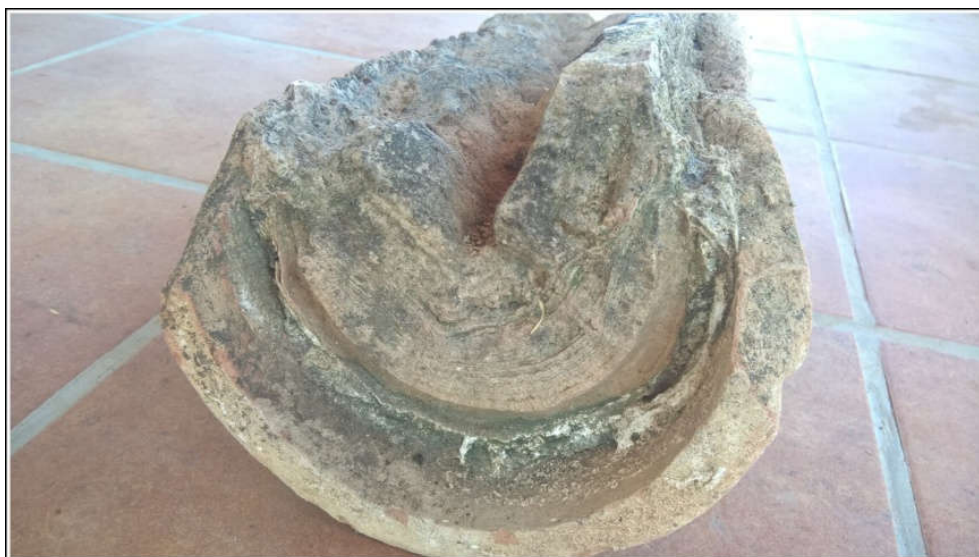
Foto (27). Obturación de un atañor de las Aguas del Cabildo perteneciente a la Huerta de Sta. María con toba calcárea precipitada.
