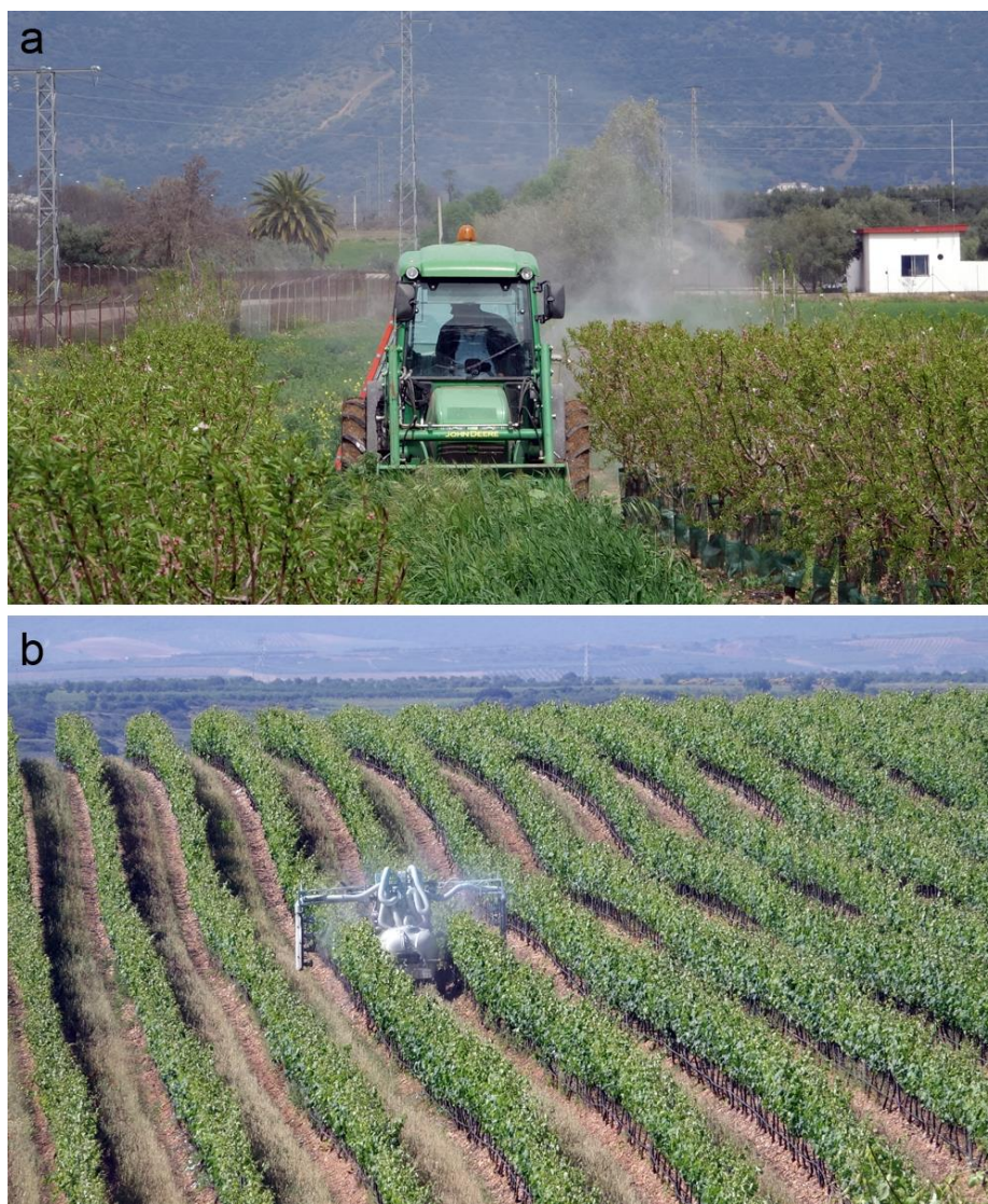
Figura 10. Deriva y exceso de aplicación de producto fitosanitario en: a) almendro en seto, y b) viñedo en espaldera. Fuente: grupo imaping.
