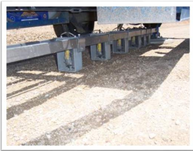
Figura 2-2 vista de lanza con geófonos apoyados sobre capa de zahorra
