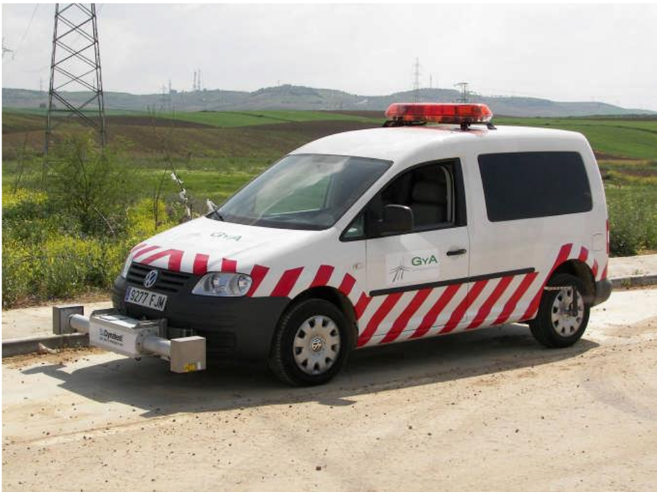
Figura 2-11 Vista perfilómetro Laser.
