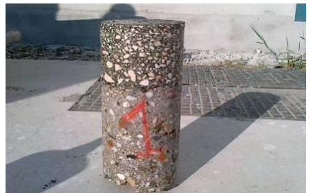
Figura 30. Probeta testigo con HSC-AR y dos capas de mezcla bituminosa
