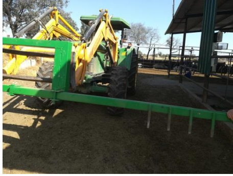
Figura 4. Arado que se usa para arar diariamente la cama de los cubículos (izqda). Aspecto de los cubículos una vez arados (dcha).
