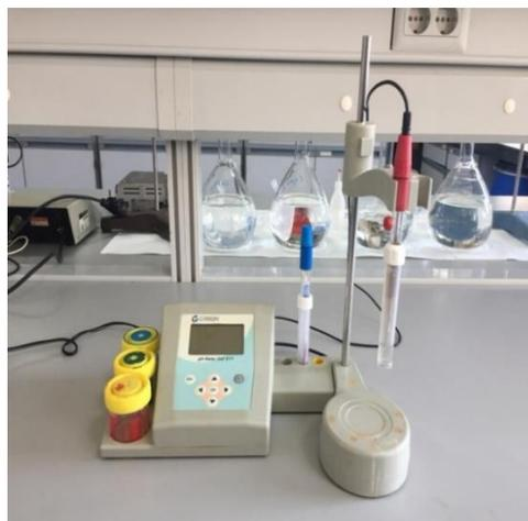
*Figure 8: Le pH mètre utilisé*
