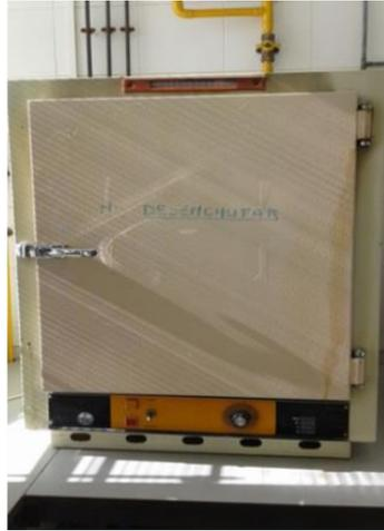
Figure 10: Four pour chauffage à 105 °C
