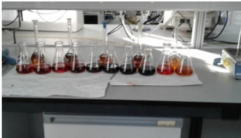
*Figure 17:Analyse de la DCO des échantillons*
