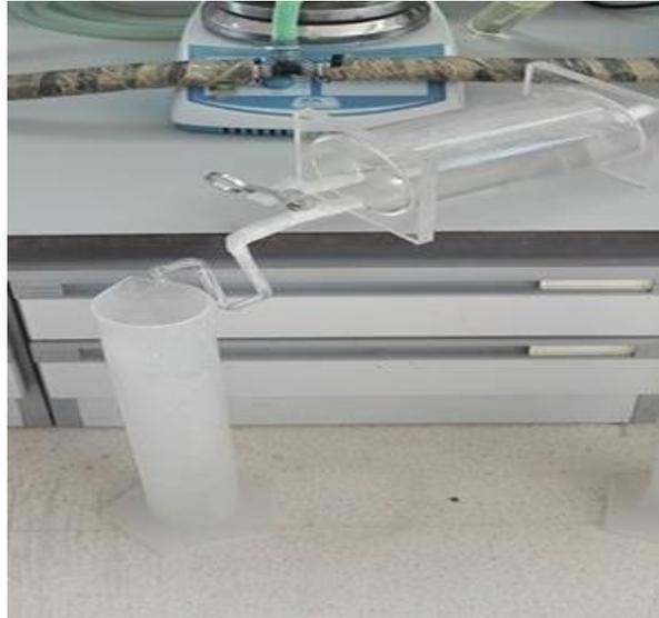
*Figure 7: Système de mesure de méthane*
