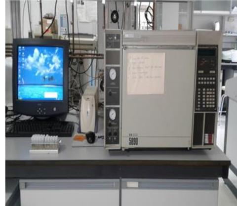
Figure 19: Chromatographe utilisé
