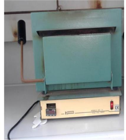
Figure 9: Four pour calcination à 550 °C
