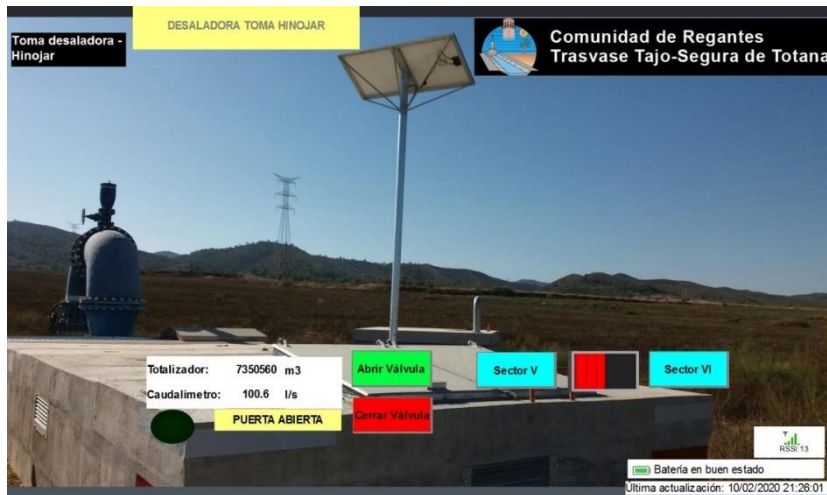
Figura 3. Interface del SCADA de la Comunidad de Regantes Traslase Tajo-Segura de Totana (Murcia)
