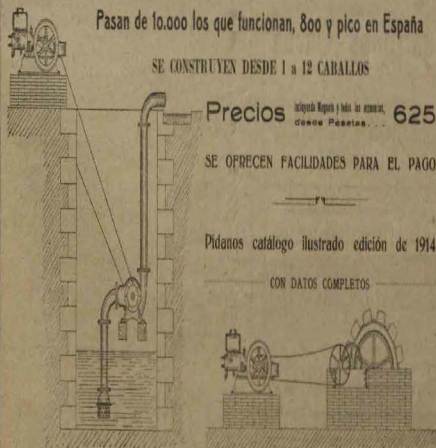
Instalación de Bomba Centrífuga
