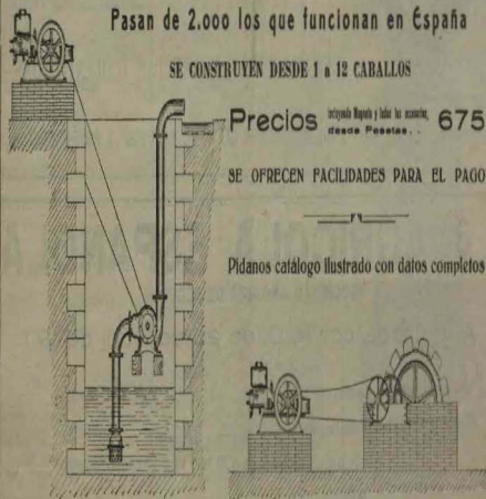
Instalación de Bomba Centrifuga
