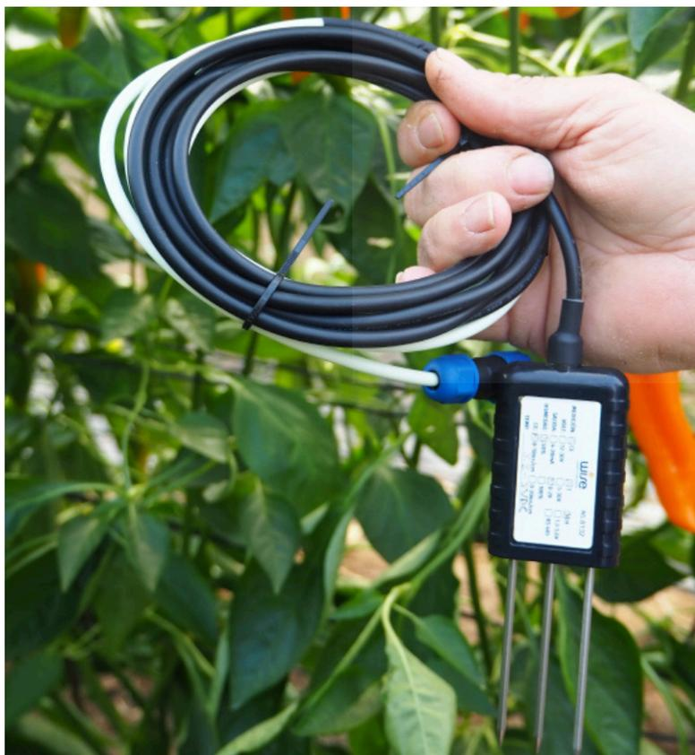
Figura 6 Sonda de humedad y conductividad eléctrica. Fuente: [www.wiseagrotecnologia.com](http://www.wiseagrotecnologia.com)
