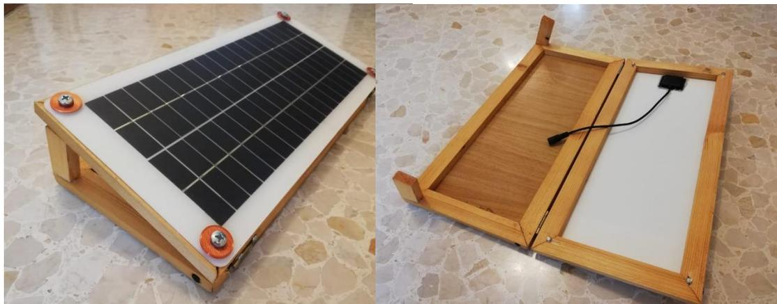
Figura 16. Panel solar con estructura de soporte e inclinación.
