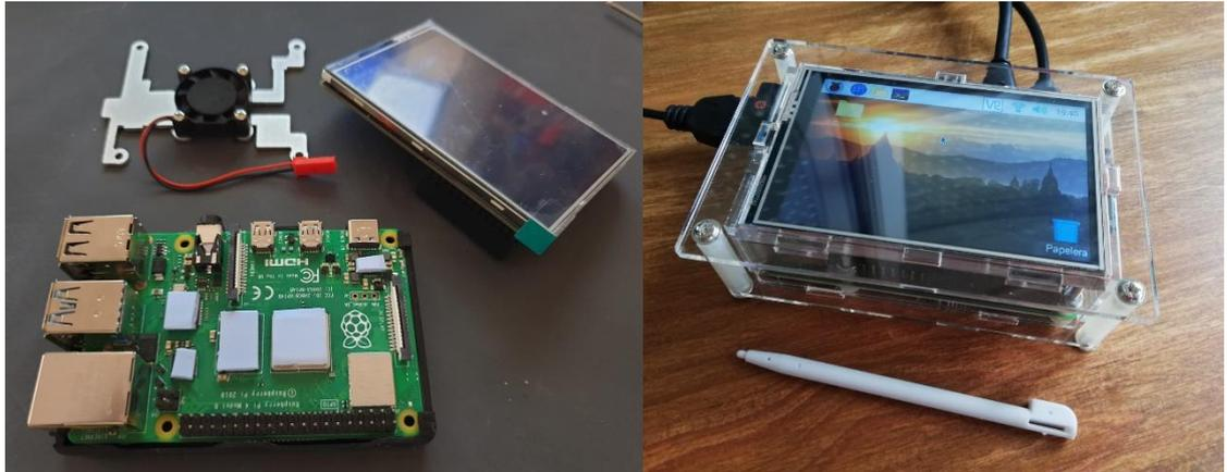
Figura 37. RPi con pantalla y carcasa acrílica.
