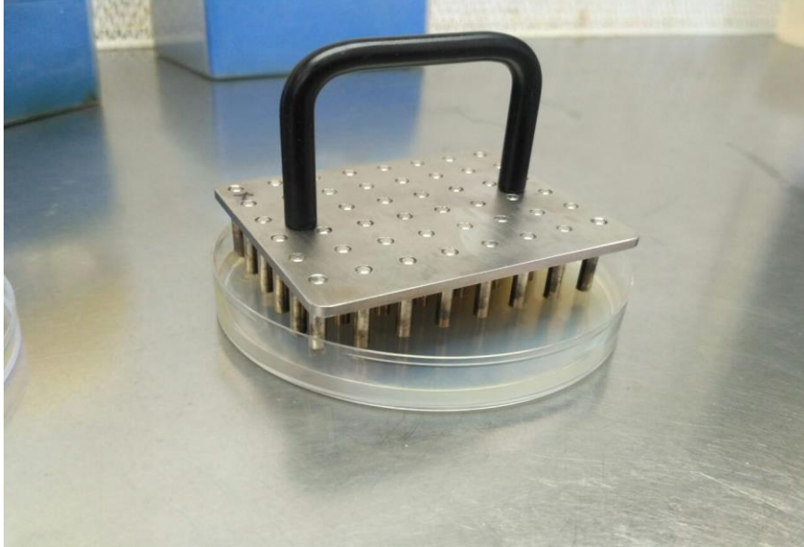
Figura 13. Ejemplo del uso del molde de replicación para realizar el test de goteo.
