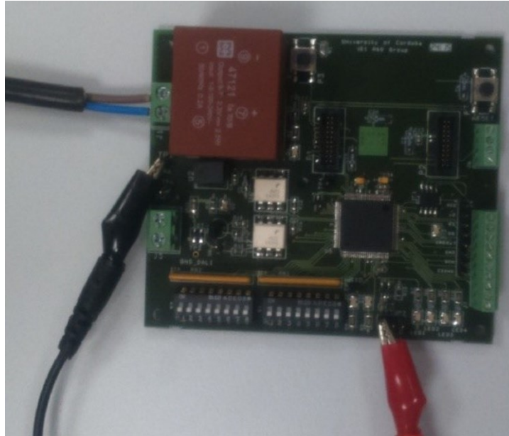
Figura 5.21 Prueba de precisión y estabilidad del voltaje de 3,3 V.
