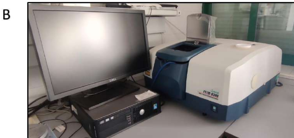
Esquema 4. (A) Diagrama de componentes de un equipo de espectroscopía IRRAS. (B) Espectrofotómetro JASCO 6300 FTIR usado en este trabajo.
