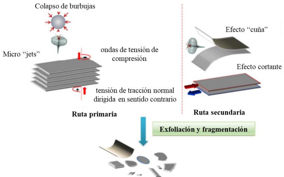
Figura 34. Ilustración del mecanismo mecánico para la exfoliación de grafeno mediante sonicación (adaptado de la referencia [387] )
