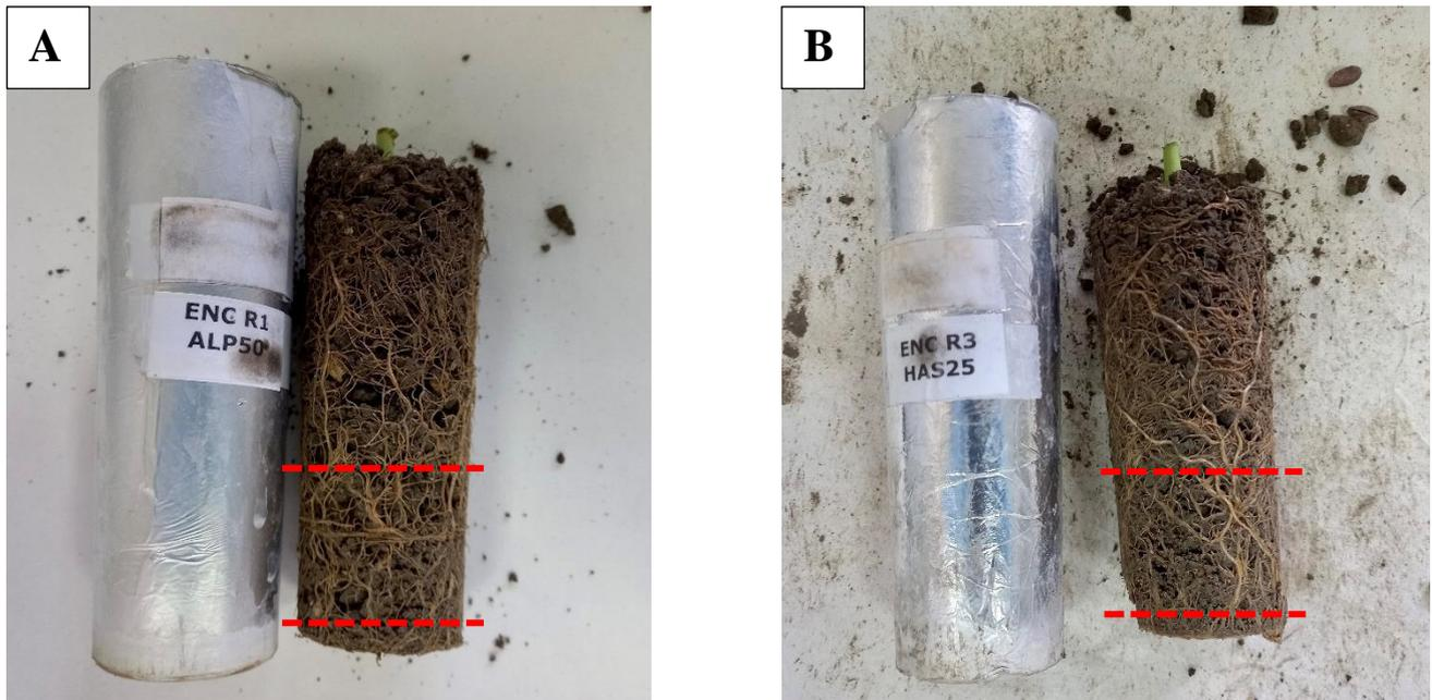
**Figura 3.11** Cilindro de suelo y porción seleccionada para el muestreo en fresco. (A) ENC ALP 50 y (B) ENC HAS 25
