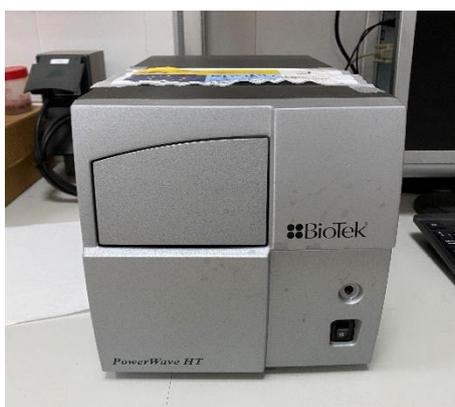
**Figura 3.3** Espectrofotómetro de microplacas BioTek PowerWave HT
