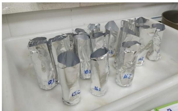
**Figura 3.2.** Cápsulas de aluminio para humedad higroscópica
