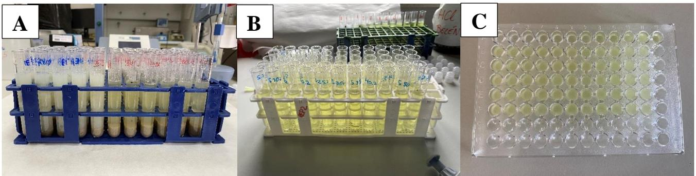
**Figura 3.13** Muestras incubadas con NaOH (las 5 filas de la izquierda ya contienen el CaCl<sub>2</sub>) (A), sobrenadante de las muestras transferido a tubos nuevos (B) y Microplaca con alícuota de muestras y patrones (C).
