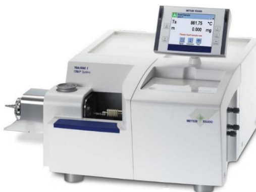
Figura 2.1.3.1. Analizador termogravimétrico TGA/DSC 1 Star System Mettler Toledo.
