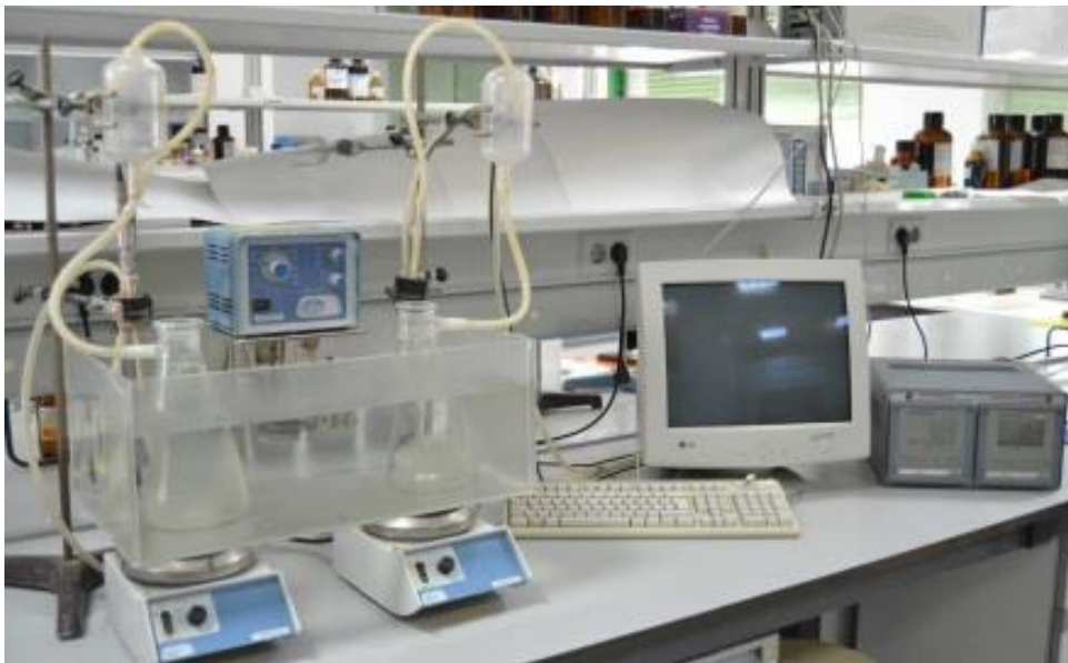
Figura 2.2.1. Respirómetro estático en fase líquida.
