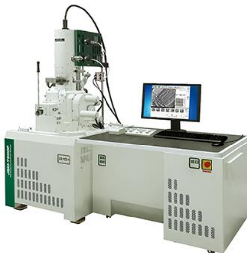
Figura 2.1.8.1. Microscopio electrónico de barrido JEOL JSM 7800F.
