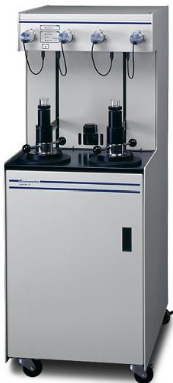
Figura 2.1.5.1. Porosímetro Micromeritics AutoPore IV 9500.
