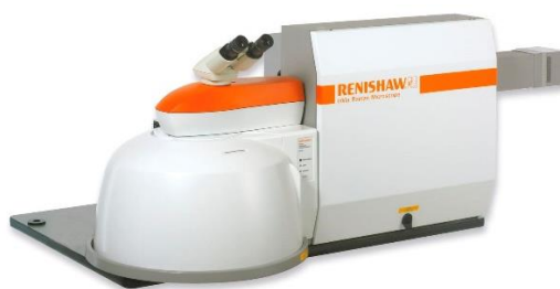
Figura 2.1.7.1. Espectrómetro Raman Renishaw (inVia Raman Microscope).
