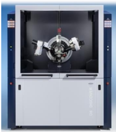
Figura 2.1.6.1. Difractómetro Bruker D8 Discover A25.
