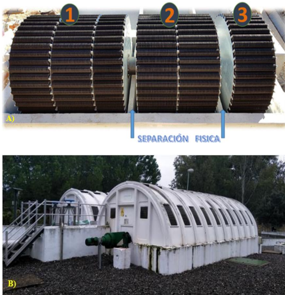
Figura 1.2.2.1. (A) Disposición en cascada de los CBR y (B) sistema de biodiscos de la EDAR de Villaviciosa de Córdoba (Córdoba).
