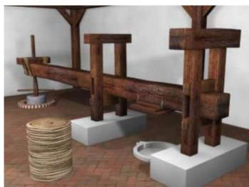
Fig. n.º 3.-Prensa de viga y quintal. Elaboración propia.
