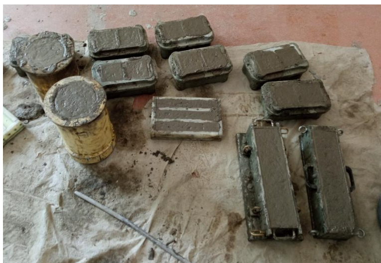
Figura 24. Conformación de probetas de los hormigones
