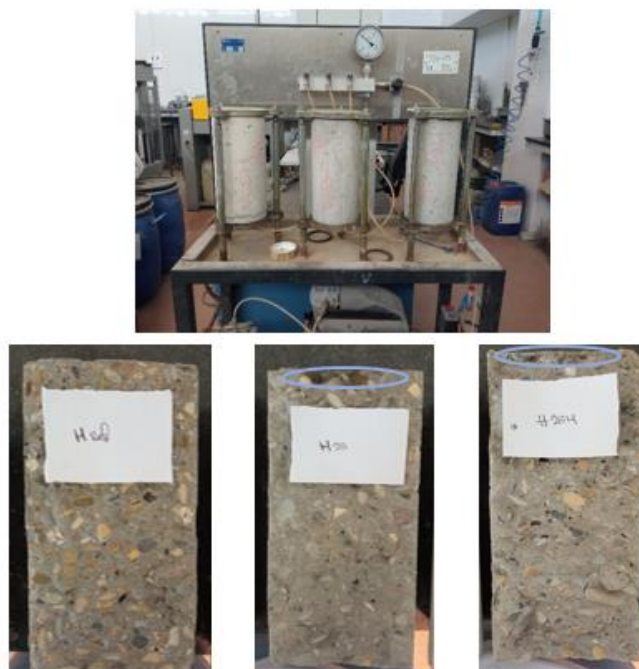
Figura 29. Penetración de agua en hormigones
