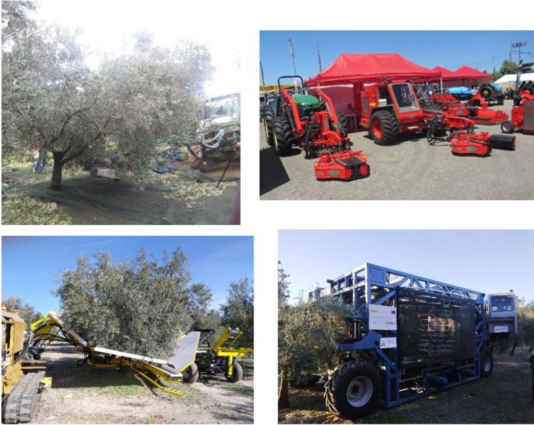
Figura 2: Máquinas de recolección de la aceituna basadas en vibradores de troncos: vibrador acoplado al tractor (arriba izquierda y derecha), vibrador autopropulsado (arriba derecha), plataformas de recogida (Doc. CPP MECAOLIVAR) (abajo izquierda) y cosechadora cabalgante (Doc. CPP INNOLIVAR) (abajo derecha).
