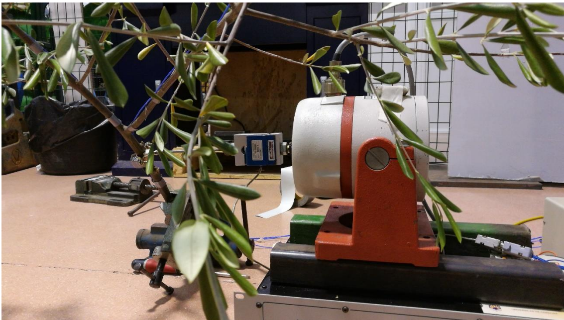
Figura 14: Detalle de ubicación de la célula de carga en el vibrador electrodinámico
