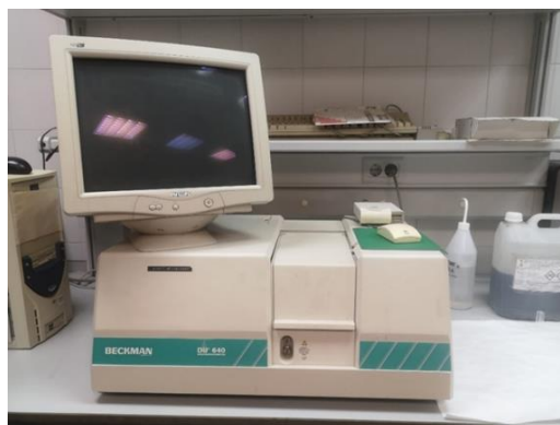
Figura 3. Espectrómetro UV-visible usado durante el trabajo.
