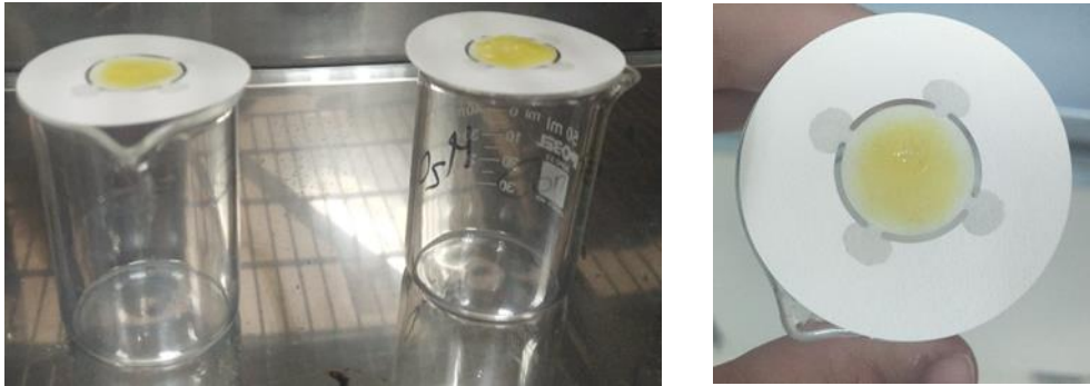
Figura 8. Microcarry empleado para la determinación del hierro por Fluorescencia de Rayos X.
