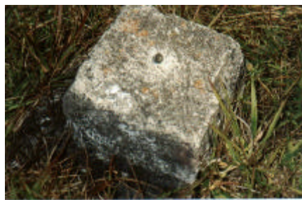
Figura XI-4. Detalle de vértice Red Geodésica Guatemala.
