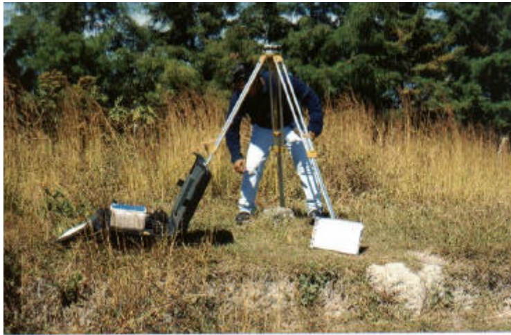
Figura XI-3. Ejemplo de observación GPS en estación de la Red Geodésica de Guatemala.
