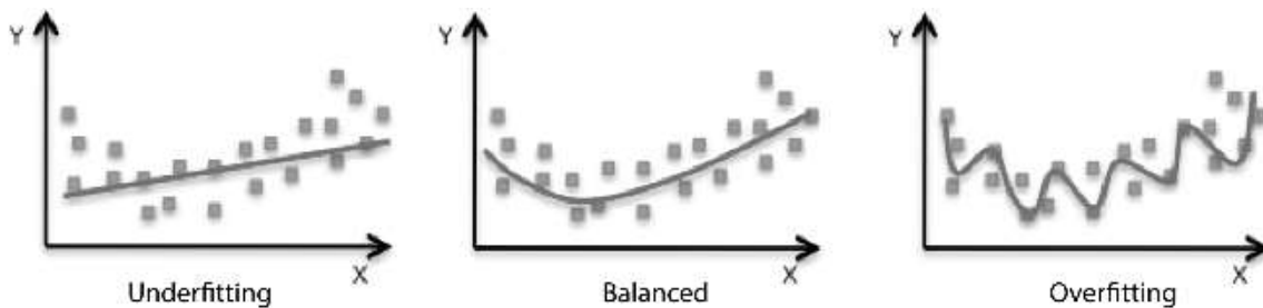
Figura 2.8. Subajuste, Equilibrado y sobreajuste [48]
